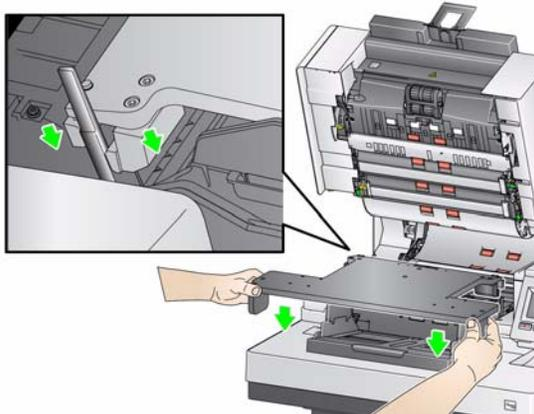
Il ripiano per alimentazione manuale dispone di due alloggiamenti per le guide laterali.
