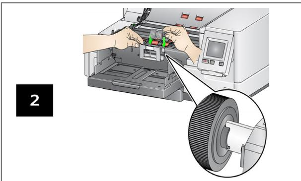
Consultare la guida dell'utente per le procedure di sostituzione del modulo di alimentazione.
